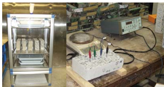
写真3 比抵抗実験(養生と測定状況)
