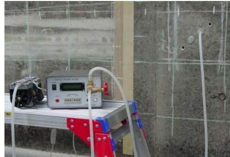
写真1 簡易透気試験の状況
